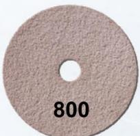
**SHINEPRO®- Pad Körnung 800** - wird hauptsächlich als erste Stufe einer „normalen“ Aufbereitung eingesetzt. Z. B. Terrazzo, Betonwerkstein, Marmor/Naturstein, sowie auch auf verschiedenen Kunststoff- oder Gummiböden (z. B. Vinyl oder PVC). Dieses Pad eignet sich hervorragend als zweite Stufe bei der Aufbereitung eines Feinsteinzeugbodens (nach der Vorarbeit mit dem 400er Pad).
