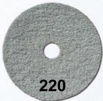
**SHINEPRO®- Pad Körnung 220** - wird hauptsächlich in der Industrie eingesetzt. Zur Reinigung und Aufbereitung stark verschmutzter Beton- oder Epoxidharzböden (Gummiabrieb sowie Bremsspuren von Gabelstaplern). Dieses Pad ist abrasiv und wird zum Entfernen von hartnäckigem Schmutz und Versiegelungen auf Beton oder Estrich verwendet.
